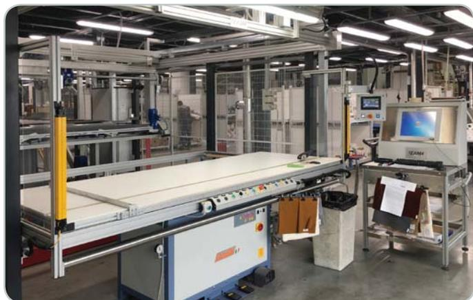
TAVOLO DOVE VENGONO EFFETTUATE TUTTE LE PROVE DI PRECONTROLLO QUALI, TAGLIO MANICHETTA, CONTROLLO ALLA MANO, PROVA ALLO STRAPPO, CONTROLLO TRAMA E CONTROLLO STABILITÀ DIMENSIONALE AL VAPORE
